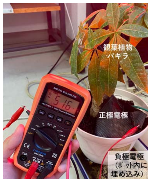
図2 観葉植物（樹木）を用いた発電確認。電圧 0.512V を測定している。
